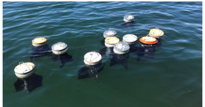
Abbildung 4: Oberflächendrifter treiben in der Nordsee als nicht-invasives Tool zur Vermessung von Strömungen, Partikel und Wassermassen. © Jens Meyerjürgens
