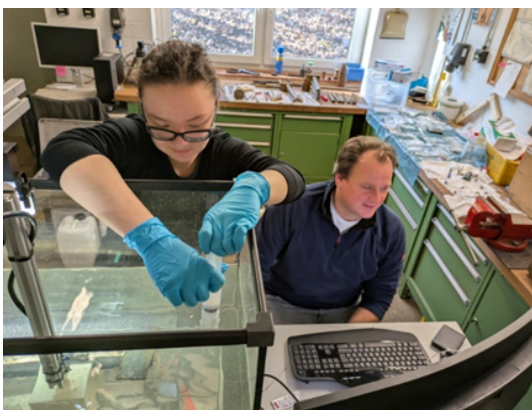
Abbildung 6: Maria Khon (links; GEOMAR) und Ansgar Leefken (rechts; URO) bei der Probenahme im Rahmen eines Strömungskanal-Experiments in der KRD S-H-Anlage. Der Strömungskanal ermöglicht die präzise Steuerung und Messung der Strömungsgeschwindigkeiten über einem festen Sprengstofffragment, während gleichzeitig Wasserproben über einen bestimmten Zeitraum hinweg entnommen werden, um die Auflösungsraten zu berechnen.
